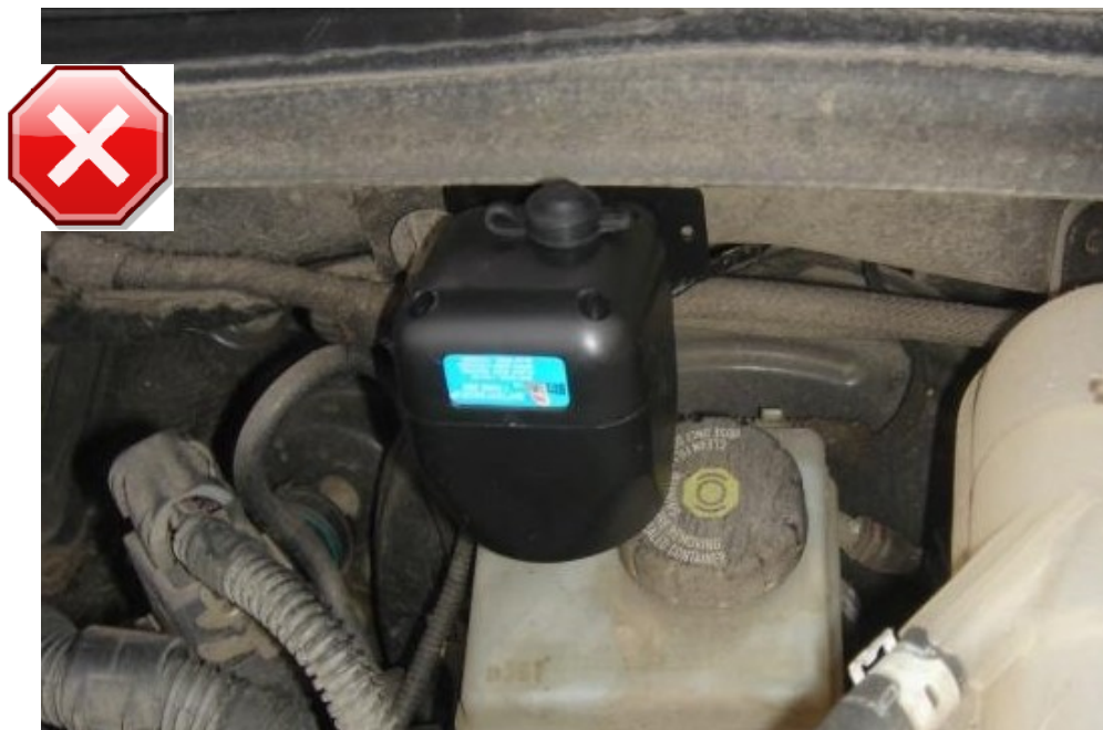
Рисунок 133. Сирена, перекрывающая крышку бачка
