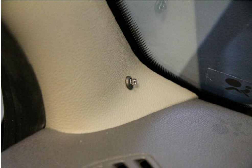
Рисунок 135. Светодиод в Рено Логан
