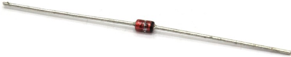
Рисунок 44. Миниатюрный стабилитрон в стеклянном корпусе
