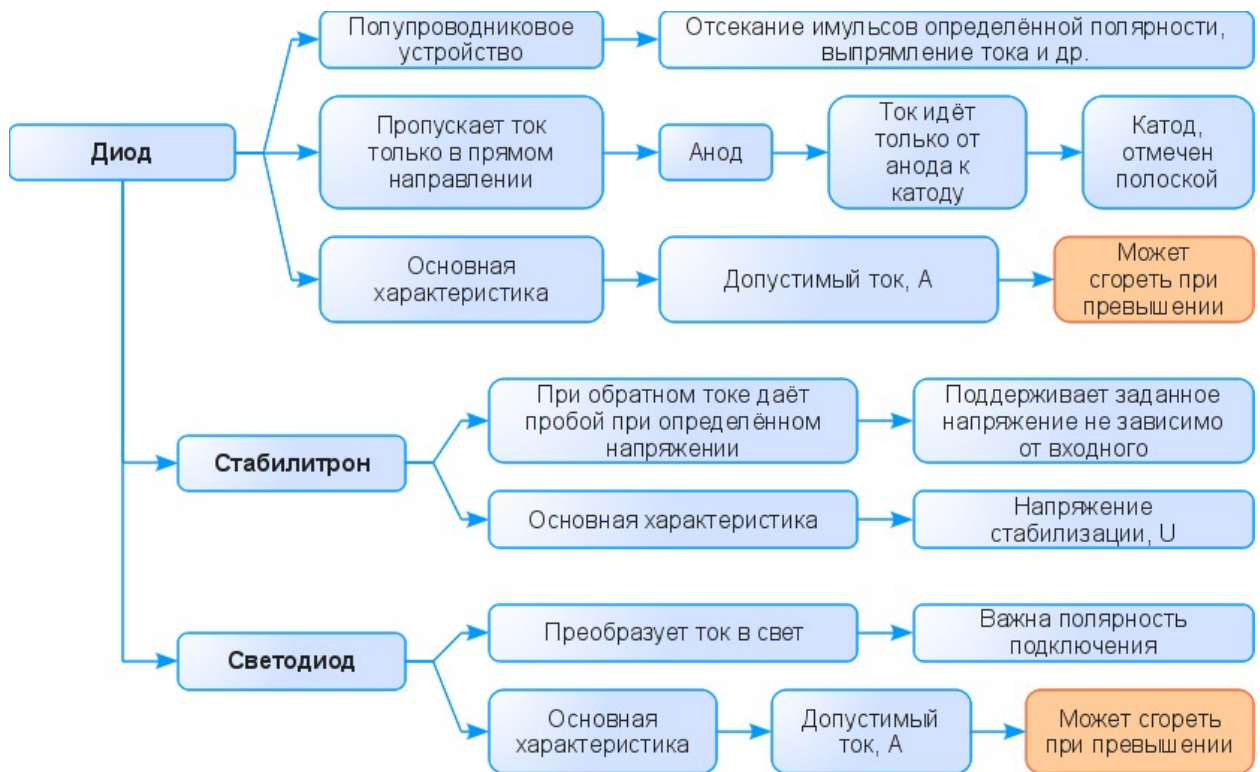
Рисунок 47. Схема-подсказка "Диод"
