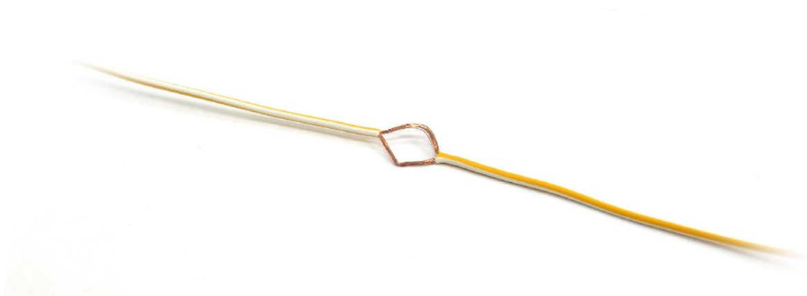
Рисунок 141. Оголение первого провода
