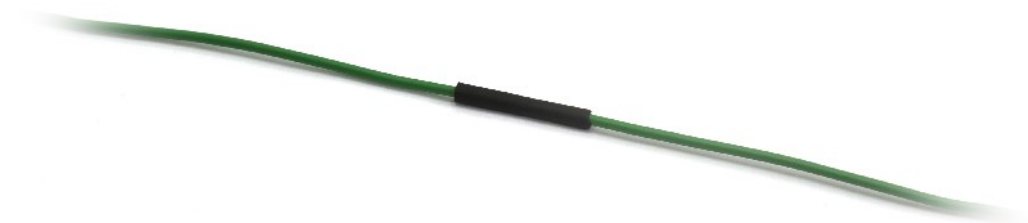
Рисунок 152. Термоусадочная трубка на пайке
