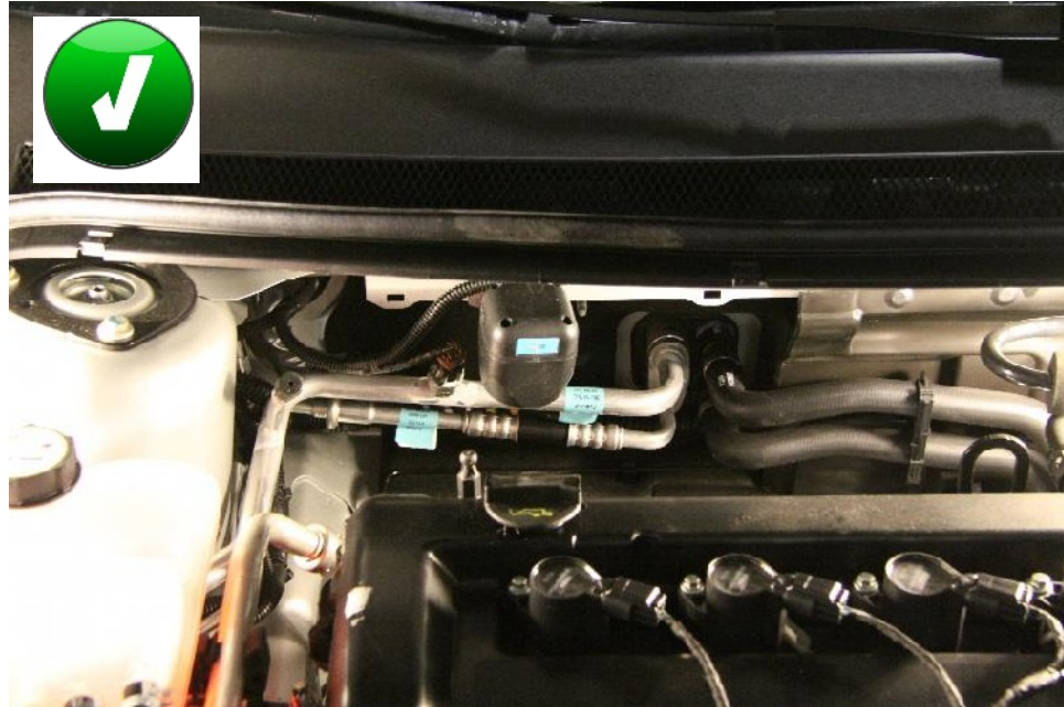
Рисунок 132. Защищенная от влаги и температур сирена
