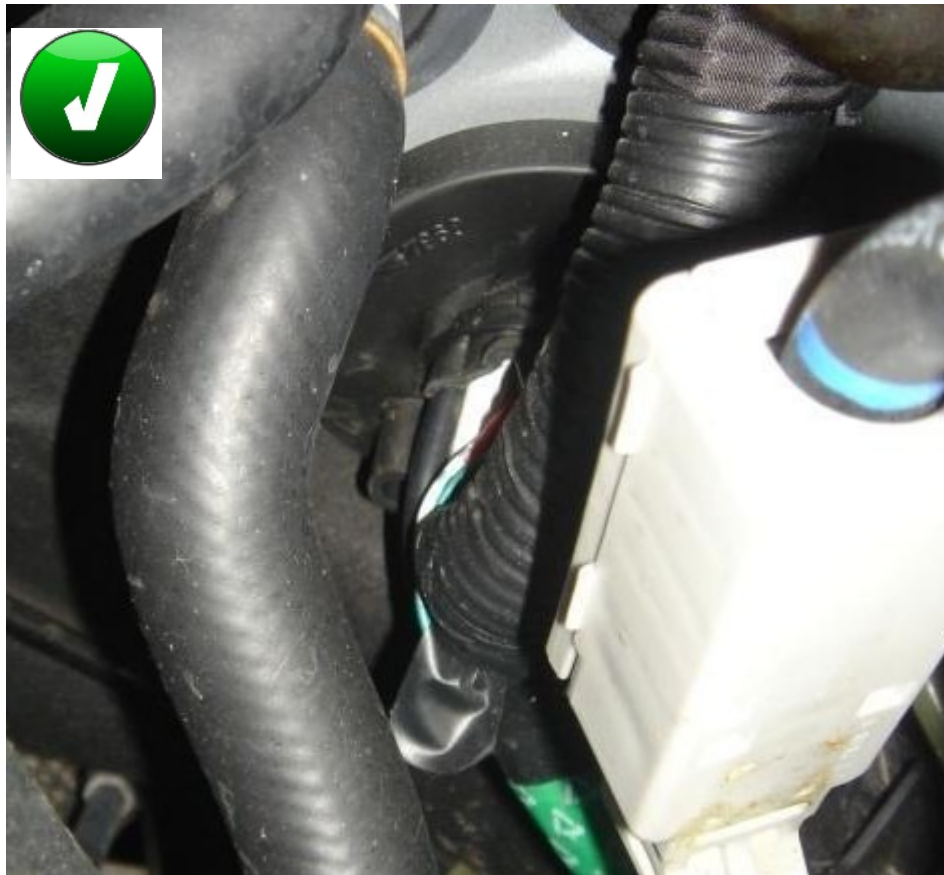
Рисунок 126. Проложенный через штатное отверстие жгут
