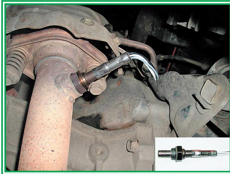
✓ Лямбда-зонд устанавливается в потоке отработавших газов двигателя и измеряет уровень содержания кислорода в них. Анализируя осциллограмму напряжения выходного сигнала лямбда-зонда на различных режимах работы двигателя, можно оценить как исправность самого датчика, так и исправность системы управления двигателем в целом.
