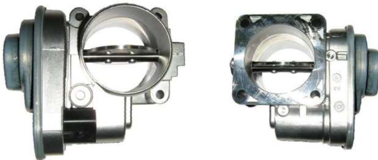
Рис. 101. Внешний вид воздухоподающего патрубка с дроссельной заслонкой
