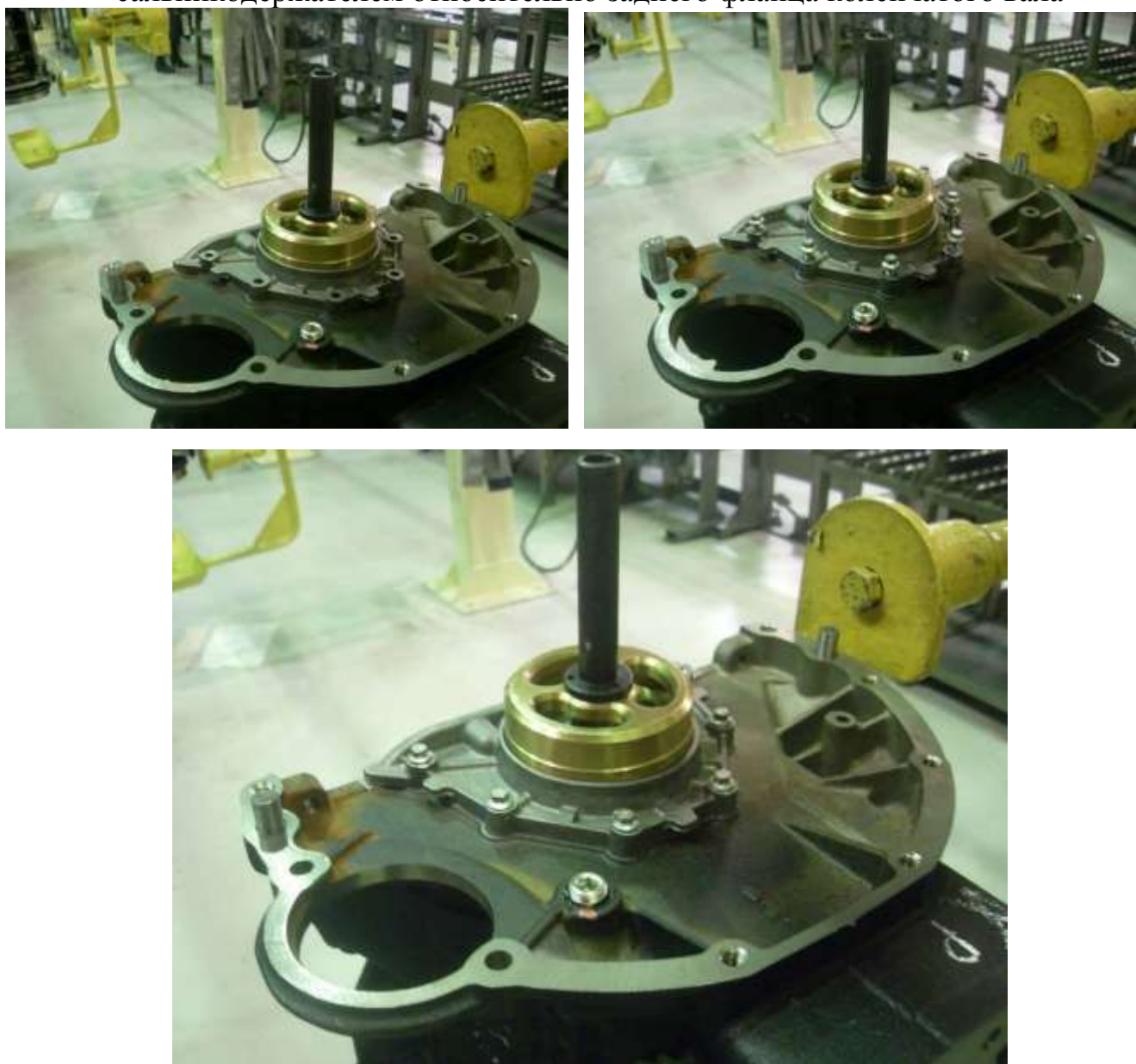
Применение оправки ЗМ 7853-4418 для центрирования заднего сальника в сборе с сальникодержателем относительно заднего фланца коленчатого вала
