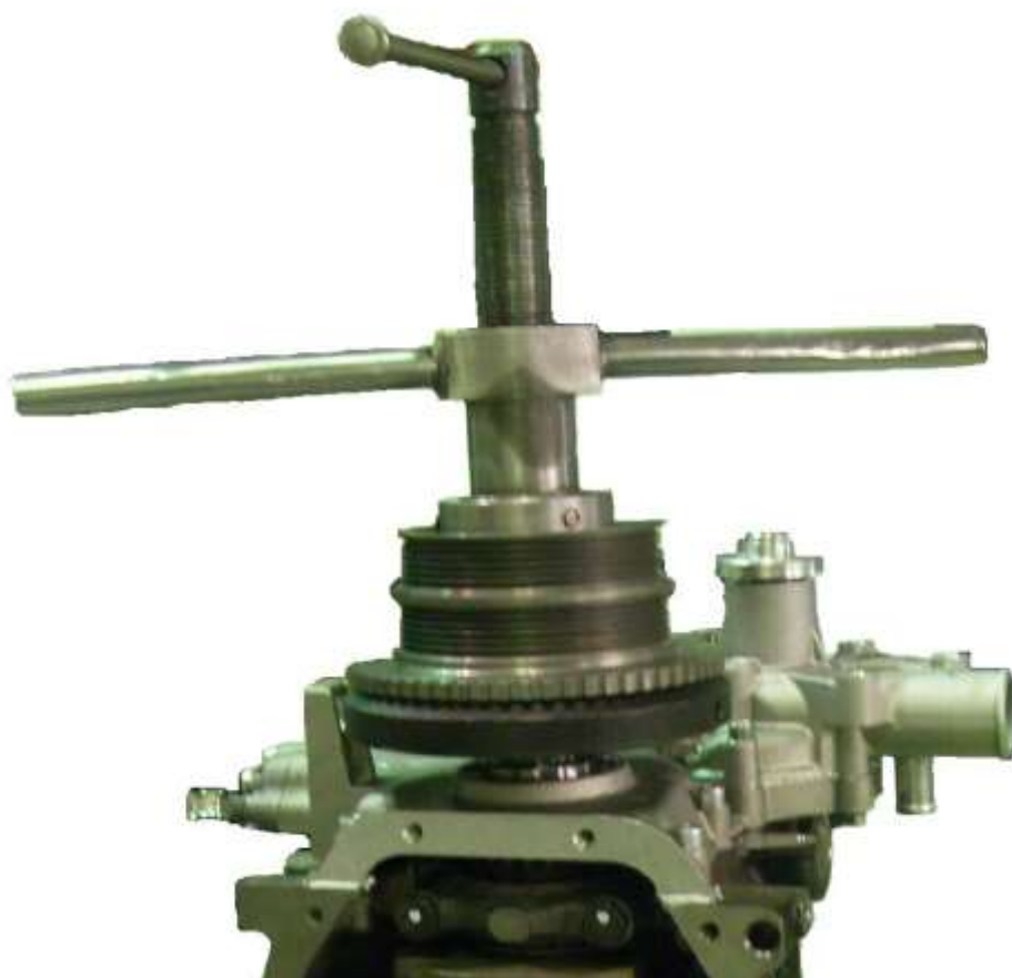
Применение приспособления ЗМ 7823-4291-04 для напрессовки шкива на коленчатый вал
