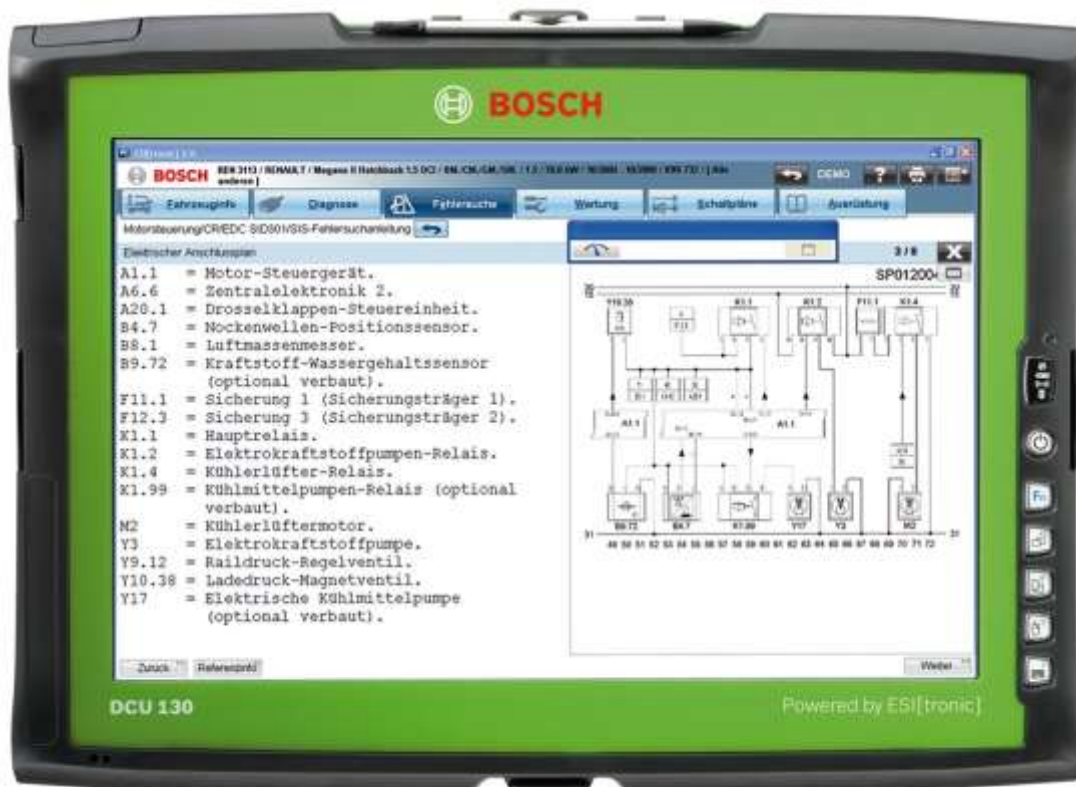
Рис. 118. DCU 130 – специализированный планшетный ПК для работы с системным тестером KTS570 для сервисного центра.
