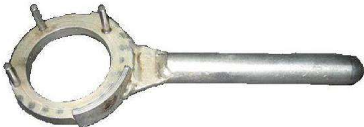
Рис. А.4 – ЗМ 7812-4791 Ключ для проворачивания звездочек распред. валов
