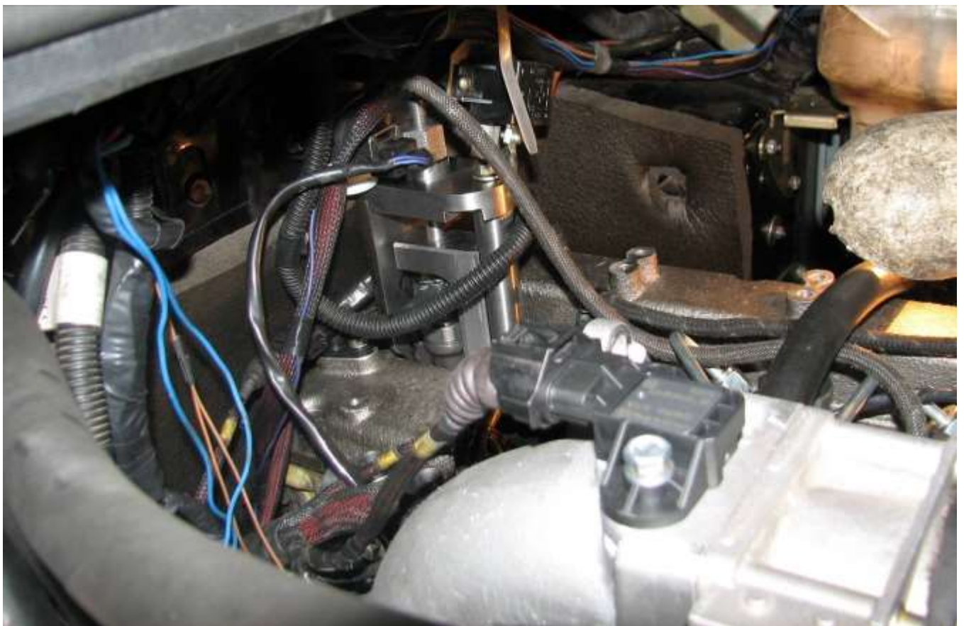
Извлечение форсунки с помощью съемника ЗМ 7823-4832 из головки цилиндров
