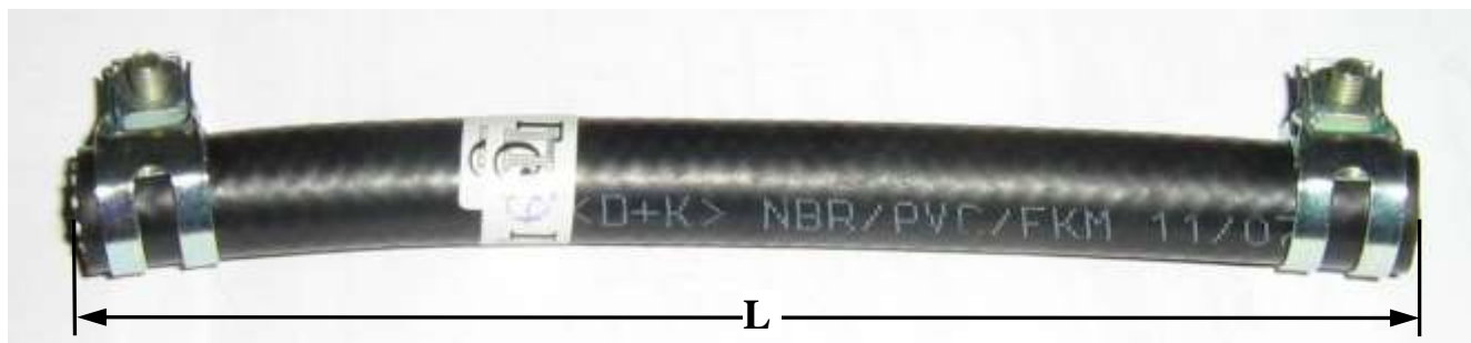
Рис. 64. Внешний вид топливопровода низкого давления в сборе с хомутами.
