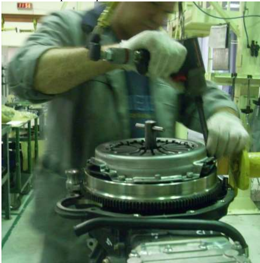
Установка сцепления с использованием оправки для центрирования ведомого диска сцепления ЗМ 7853-4023 и фиксатора коленчатого вала ЗМ 7820-4550
