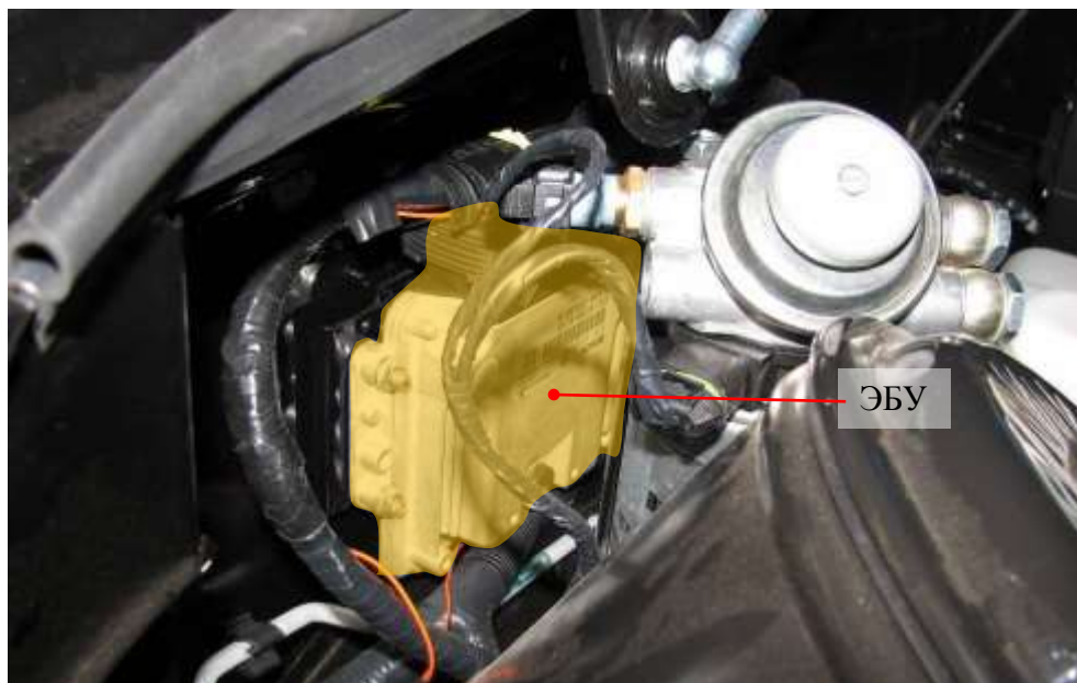
Рис. 85. Расположение ЭБУ в моторном отсеке автомобилей УАЗ-31638 Патриот, УАЗ-23638 Пикап, УАЗ-23608 Карго.
