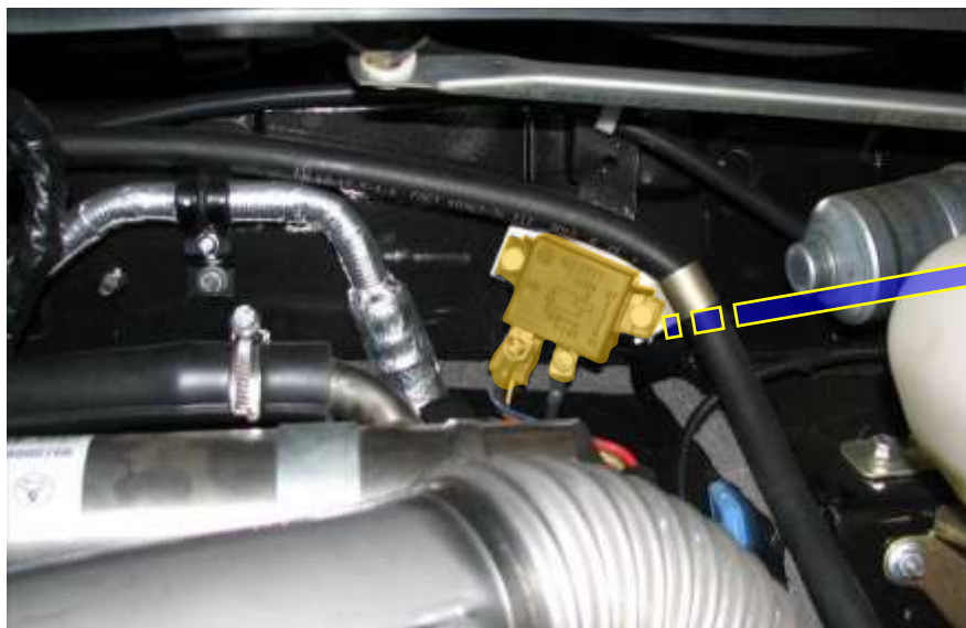
Рис. 105. Реле свечей накаливания 16.3777 (3151-48-3747040-00):
