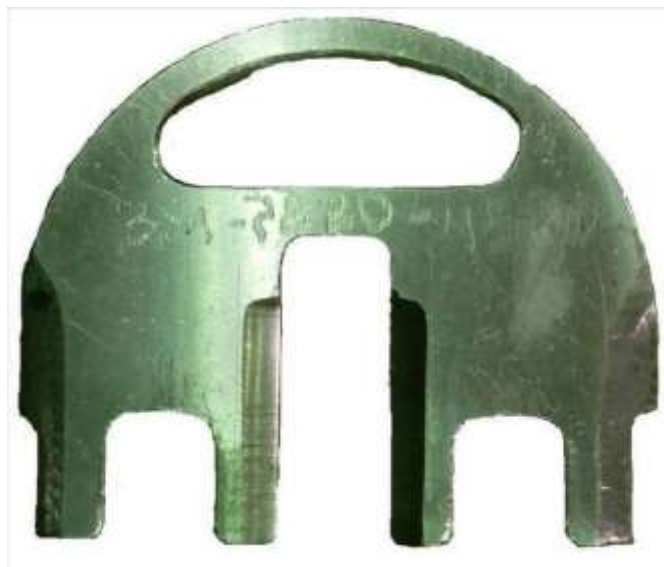
Рис. А.3 – Приспособление для фиксации распределительных валов ЗМ 7820-4580
