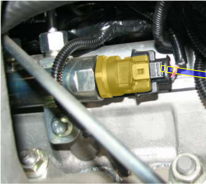
Рис. 98. Внешний вид и расположение датчика давления топлива
