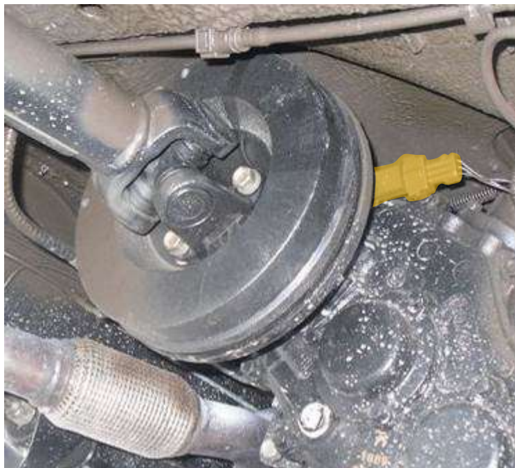
Рис .97. Внешний вид и место установки датчика скорости автомобиля
