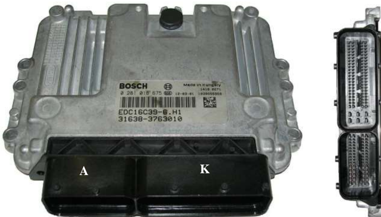
Рис. 86. Внешний вид ЭБУ модели EDC16C39-6.H1: «А» 60-контактный электрический соединитель – для компонентов на двигателе; «К» 94- контактный электрический соединитель – для компонентов на автомобиле.
