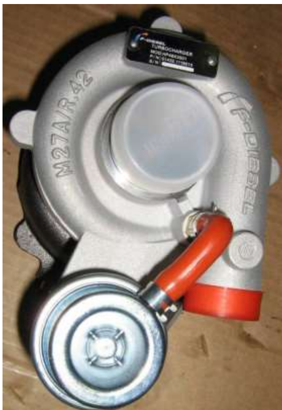
Содержание и расположение идентификационной таблички на ТКР HP48X3501
