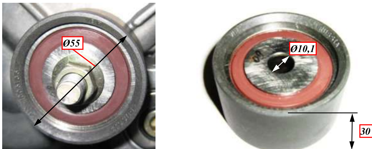
Рис. 43. Внешний вид и основные геометрические размеры опорного ролика 3413-1006135 (830700AE3P52Q5/W47 - обозначение ЗАО «ВПЗ»)
