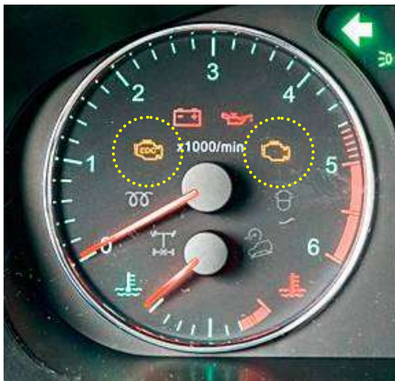
Рис. 115. Расположение индикаторов неисправности узлов системы управления двигателем на панели приборов УАЗ-31638 Патриот, УАЗ-23638 Пикап, УАЗ-23608 Карго.
