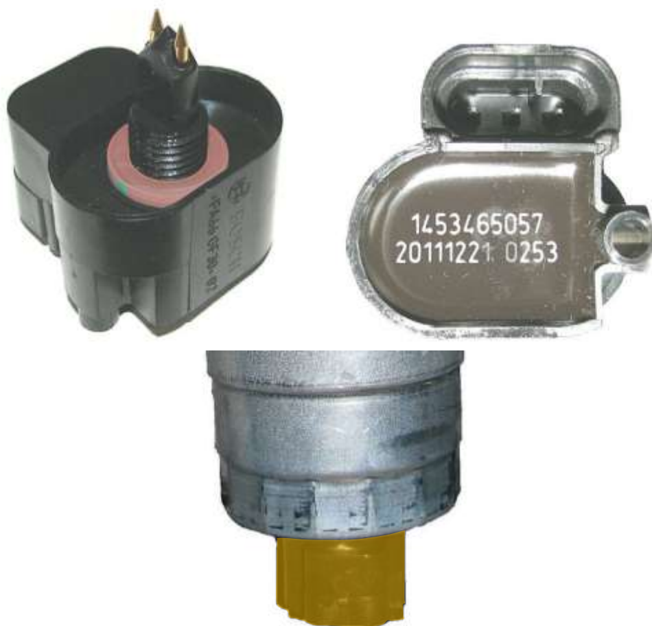
Рис. 96. Внешний вид и расположение датчика наличия воды
