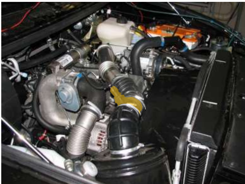
Рис. 91. Место размещения ДМРВ в системе впуска
