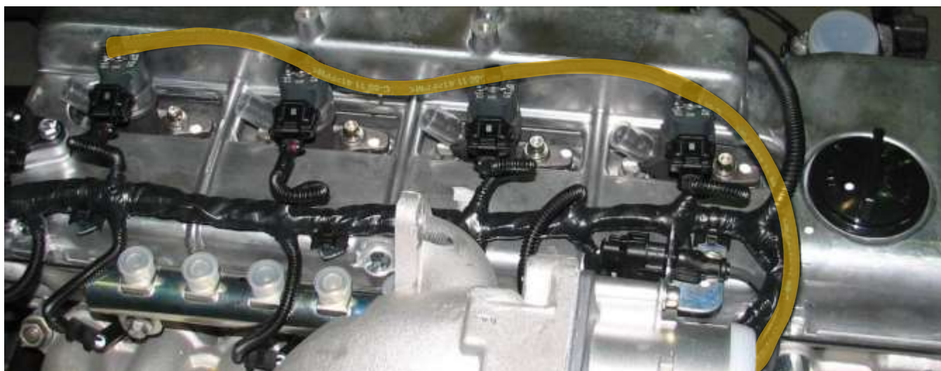
Рис. 66. Внешний вид топливопровода отсечного топлива.
