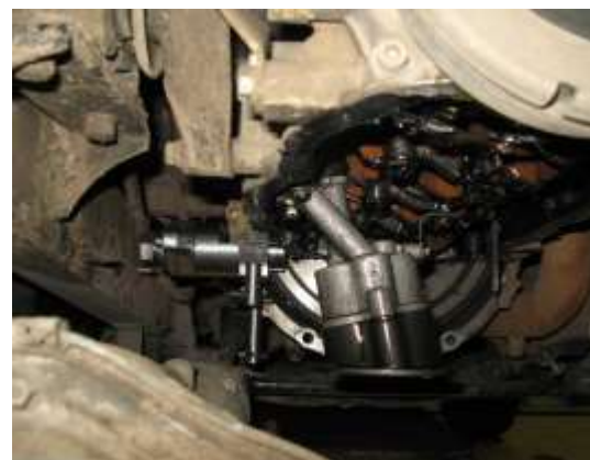
Снятие масляного картера установленного на герметик Loctite 5900 с помощью приспособления 3М 7823-4815
