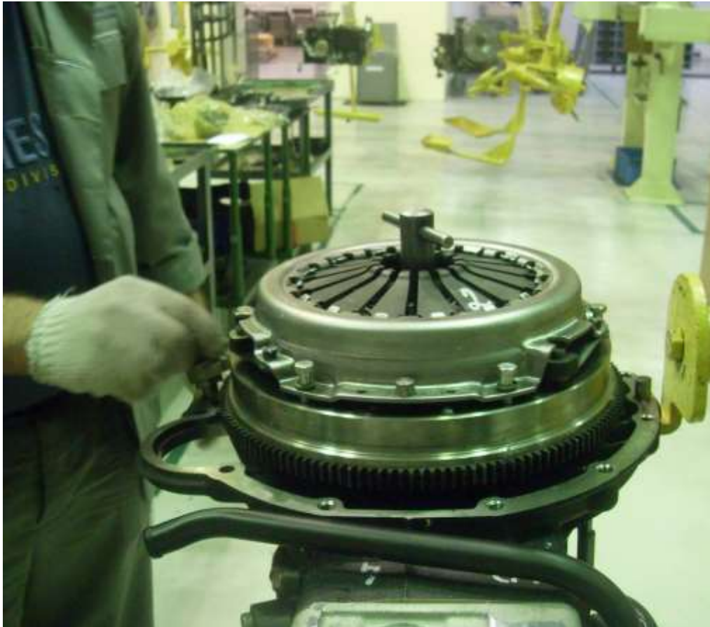
Установка фиксатора коленчатого вала ЗМ 7820-4550
