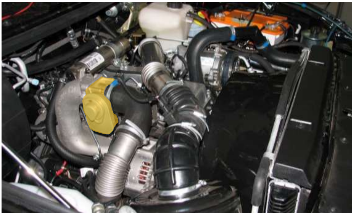
Рис. 102. Место установки патрубка с дроссельной заслонкой с электроприводом
