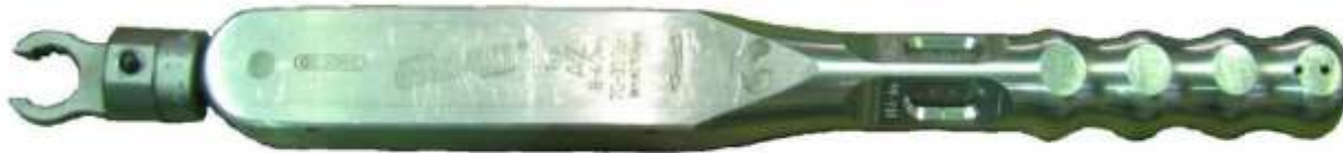
Рис. А.27 – Динамометрический ключ для затяжки гаек топливопроводов высокого давления. Дремометр №7460-01 AZ A+S (0,8-4,0кгсм) Ø 16мм + Вставная накидная насадка с открытым зевом № 8797-17, код 1211706, ф. Gedore.
