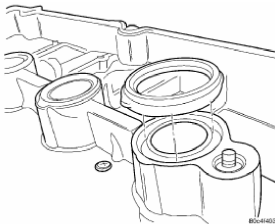
Рис. 22. Уплотнения свечных гнезд.
