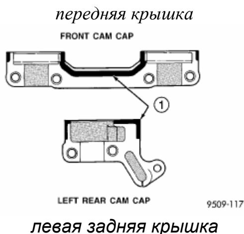
Рис. 21. Уплотнение крышек подшипника распредвала.
