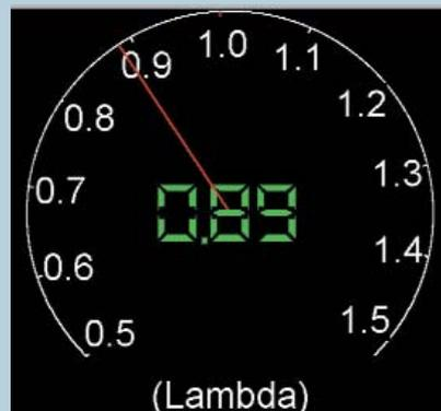
Рассчитывается значение соотношения Воздух/Топливо или значения коэффициента Лямбда по измеренному уровню содержания кислорода в отработавших газах.
