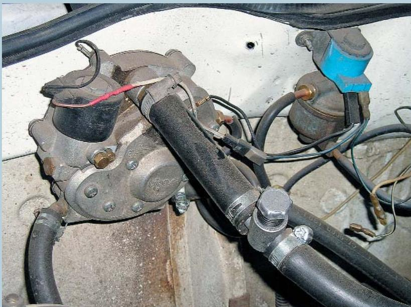
вход редуктора второй ступени (дозировочный). Во многих редукторах значение давления на выходе понижающего редуктора в значительной мере зависит от давления газа на его входе, то есть в газовом баллоне - повышение давления на входе вызывает некоторое повышение давления
