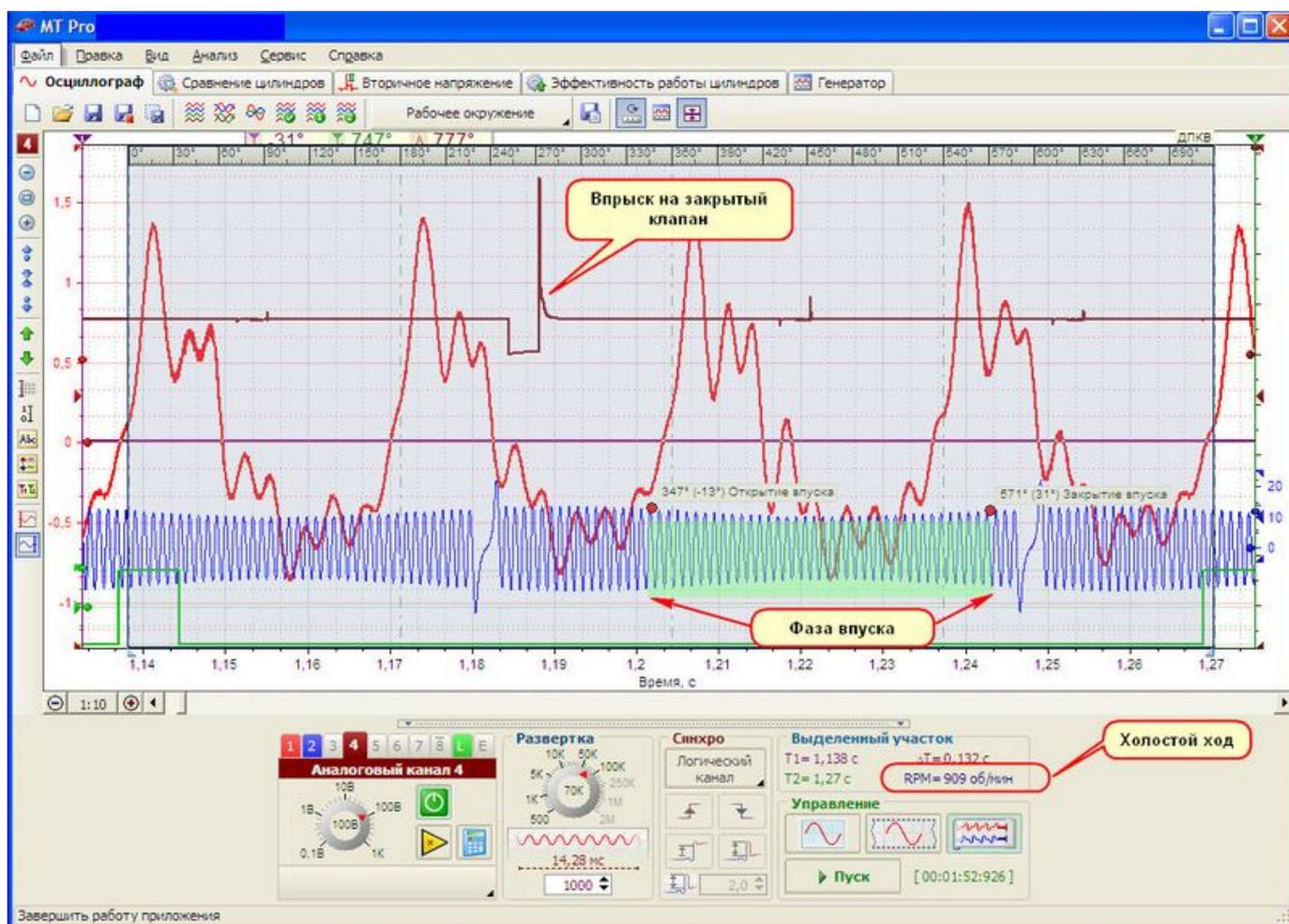
**Малые нагрузки.** При малых нагрузках и оборотах фаза впрыска плавно смещается к точке открытия впускного клапана и переходит ее. Это позволяет избежать всяких нестабильностей в переходном режиме от холостого хода к частичным нагрузкам:
