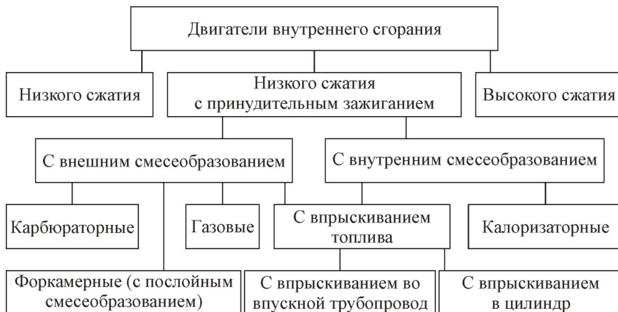
Рис. 1. 1. Общая схема классификации двигателей
