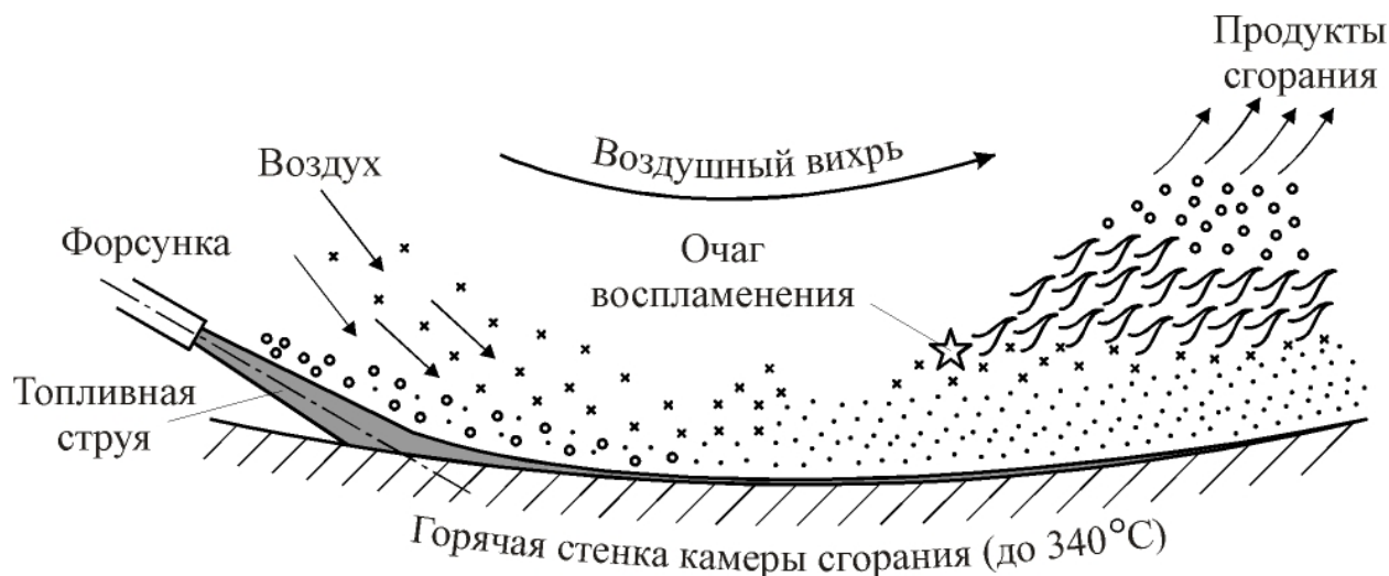
Рис. 6. 16. Схема плёночного смесеобразования и сгорания
