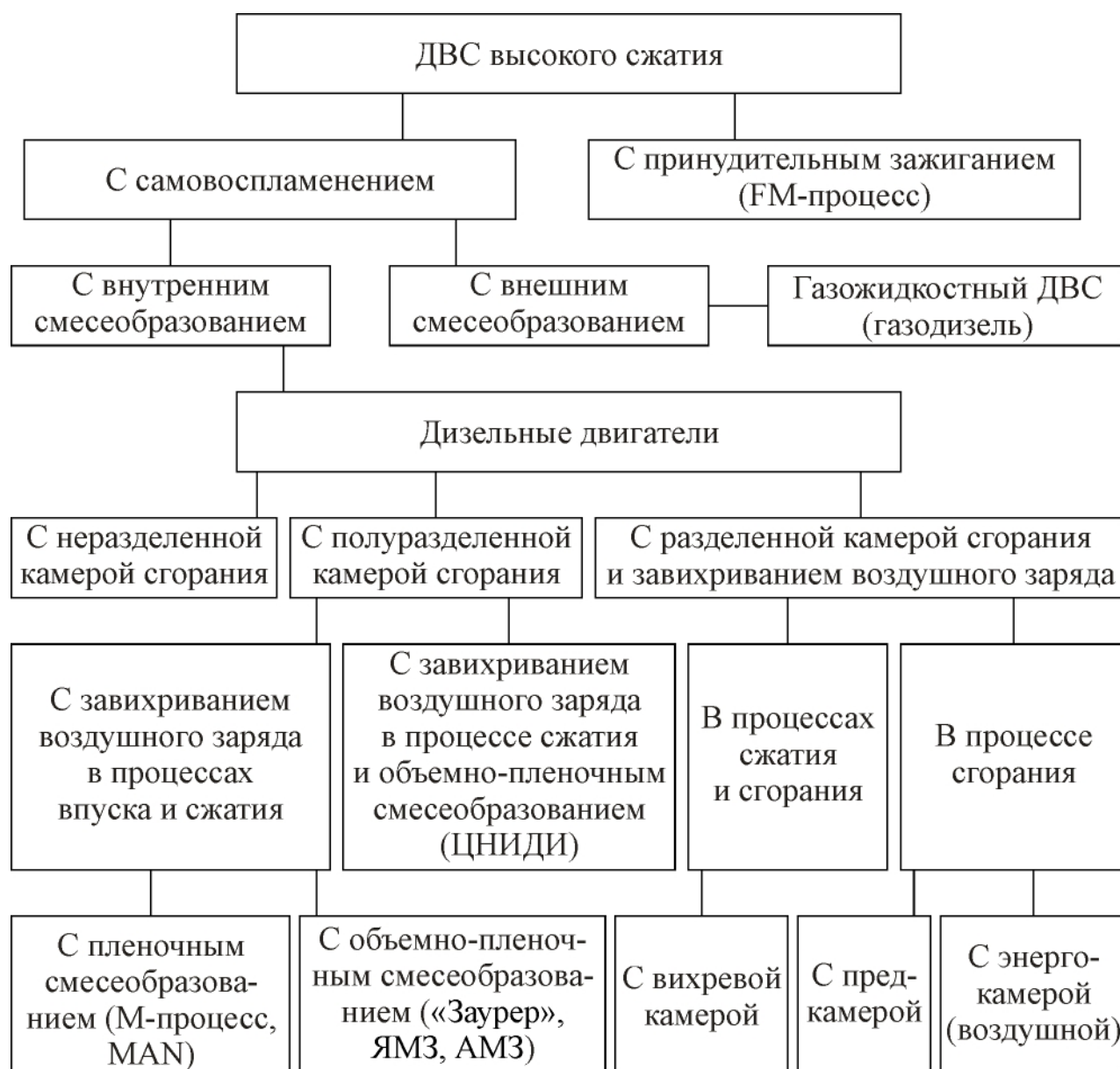
Рис. 1. 2. Схема классификации двигателей высокого сжатия
