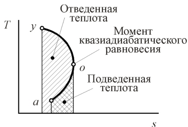
Рис. 3. 4. Тепловая диаграмма процесса сжатия
